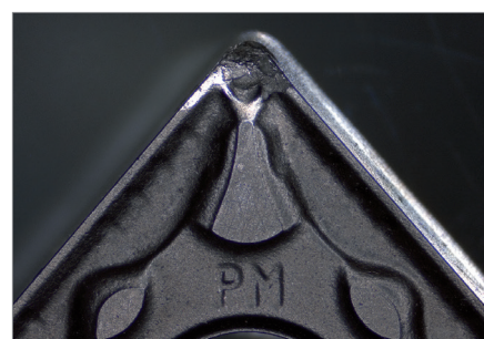
Płytko wielostrzowa, widoczne zużycie narzędzia; światło odbite, oświetlenie pierścieniowe, zoom 0.8x
