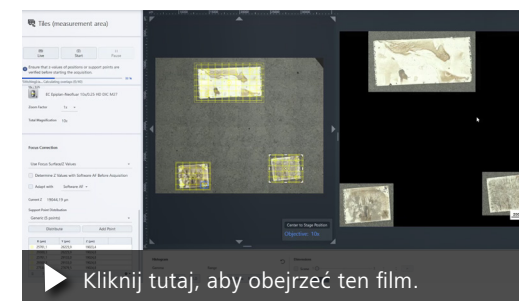
Wspomagana akwizycja – automatyczne definiowanie obszarów do szczegółowego skanowania z obrazu ogólnego
